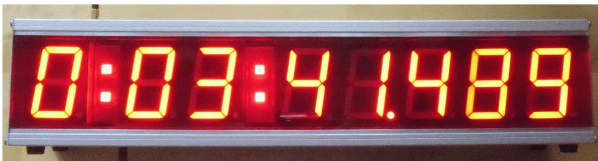
Anzeige der laufenden Stoppuhr mit 1ms Auflösung und 10h Umfang
